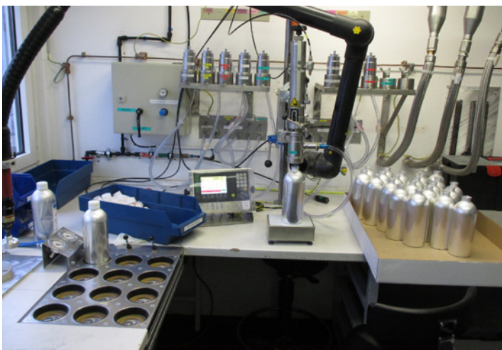
Arbeitsplatz zum Abfüllen der Rohstoffe in die verschiedenen Gebindegrößen
