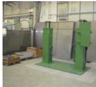
Die Hebeelemente des Mixers sind installiert und fixiert – diese Elemente heben den 4,5 to schweren Maschinenkopf an, um die Kessel einfahren zu können.
