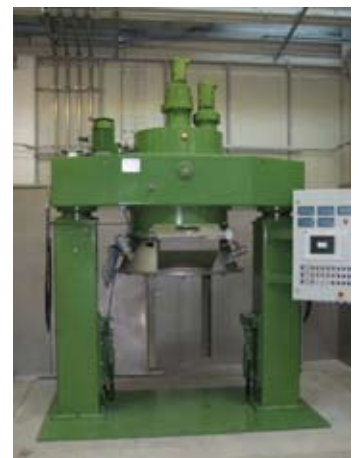
Der abgesenkte neue Mixer, der bald in Produktion gehen wird. In den nächsten Wochen und Monaten werden wir Schritt um Schritt alle Rezepte an das neue Mischprinzip anpassen und optimieren. Somit können wir die Produktionskapazität nach Bedarf deutlich erweitern.
