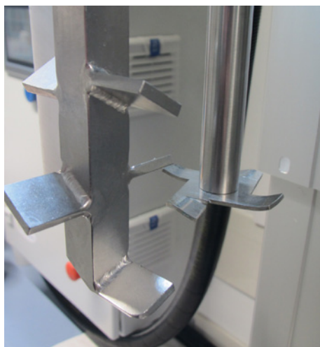
Links der Balkenrührer, rechts die Dissolverscheibe
