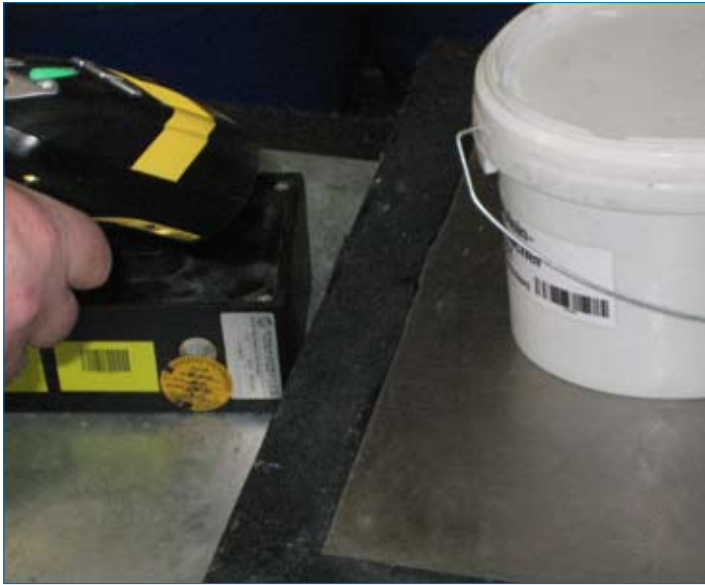
Bild 3: Rohstoff mit Vorwiegegebinde scannen und abwiegen
