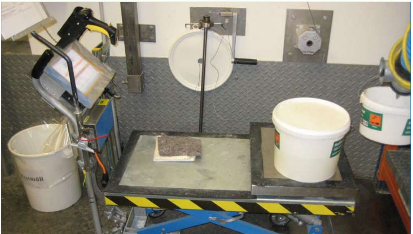
Bild 4: mobile ATEX-Waage im Vorwiegebereich mit Scanausstattung
