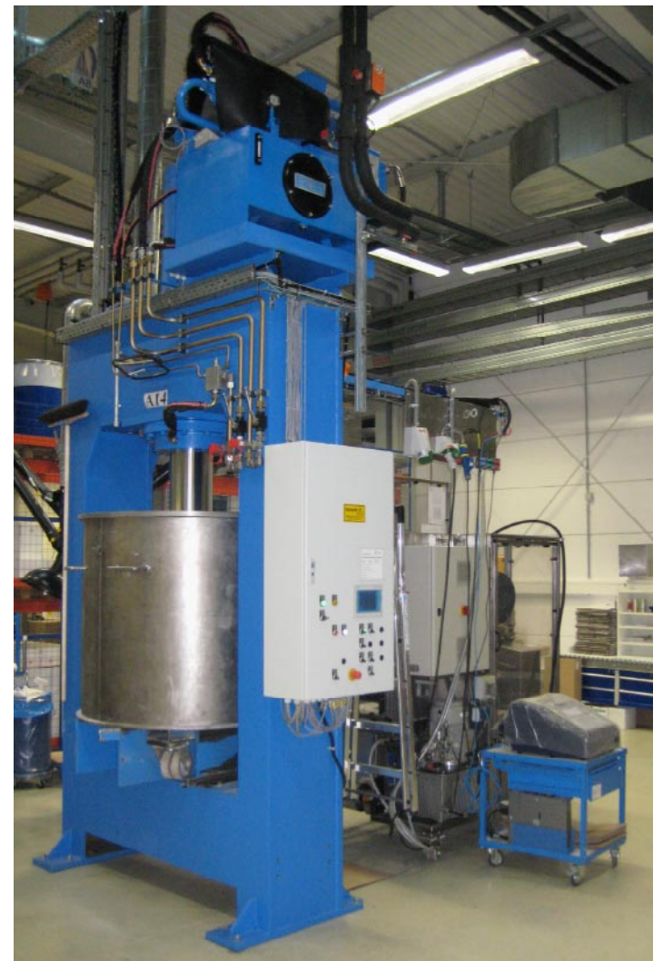
A14 gerüstet für Beutelabfüllung
